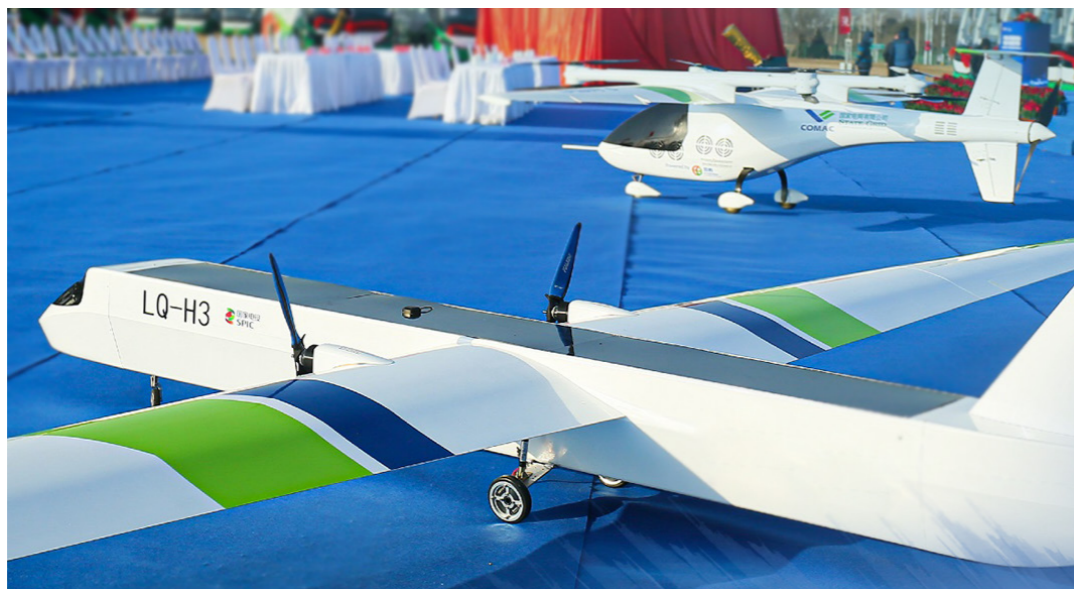
搭载“氢腾”空冷燃料电池系统的灵雀-H氢动力无人机
